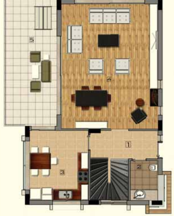
TİP 1 A-B-D BLOK ZEMİN KAT TOPLAM KULLANIM ALANI: 100 m 2 1- KORİDOR- MERDİVEN : 12 m 2 2- WC : 5 m 2 3- MUTFAK : 16 m 2 4- SALON : 45 m 2 5- TERAS : 22 m 2
