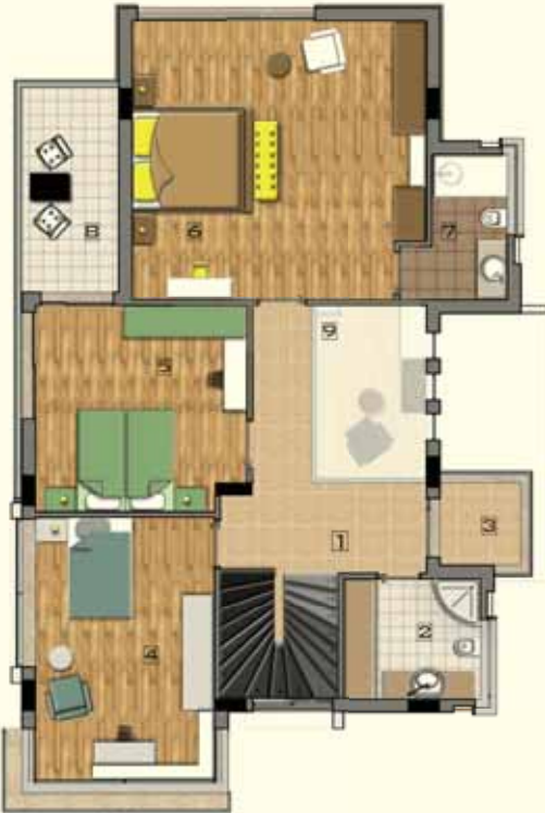
TİP 1 A-B-D BLOK BİRİNCİ KAT TOPLAM KULLANIM ALANI: 119 m 2 1- HOL : 16 m 2 5- YATAK ODASI : 18 m 2 2- BANYO : 8 m 2 6- EBV, YATAK ODASI: : 32 m 2 3- BALKON : 3 m 2 7- BANYO : 7 m 2 4- YATAK ODASI : 19 m 2 8- GALERİ : 7 m 2 9- BALKON : 9 m 2
